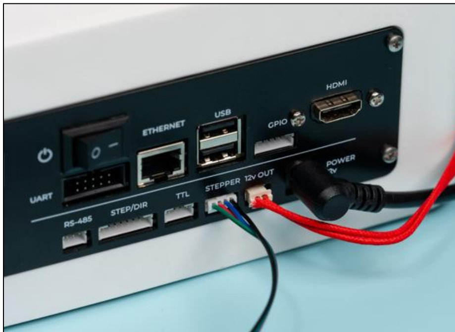
Рисунок 27 – Подключение проводов экструдера
