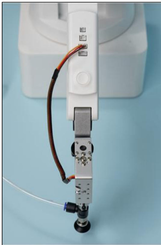
Рисунок 16 – Подключение проводов поворотного модуля
