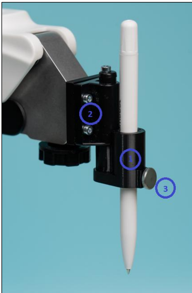
Рисунок 21 – Модуль захвата пишущего инструмента, где: 1 – захват пишущего инструмента; 2 – держатель захвата; 3 – винт
