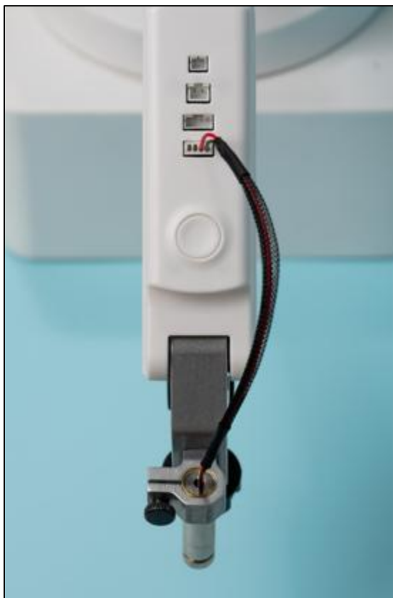
Рисунок 30 – Подключение проводов лазерной головки
