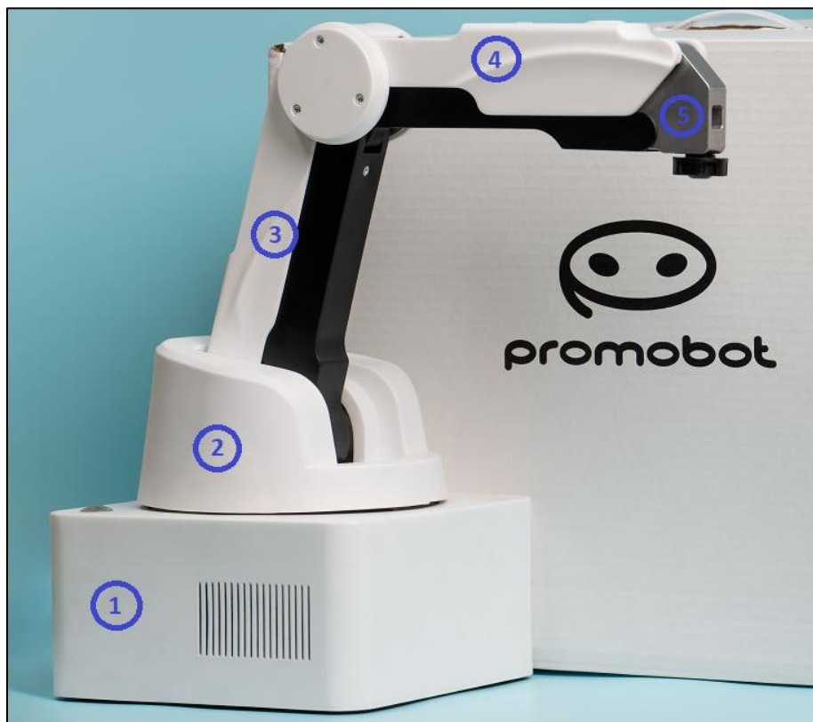
Рисунок 7 – Манипулятор, где 1 – основание; 2 – башня; 3 – плечо; 4 – стрела; 5 – блок инструмента
