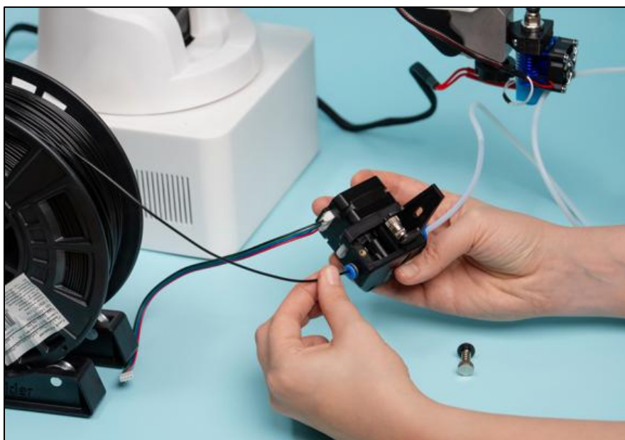
Рисунок 26 – Заправка пластиковой нити в экструдер
