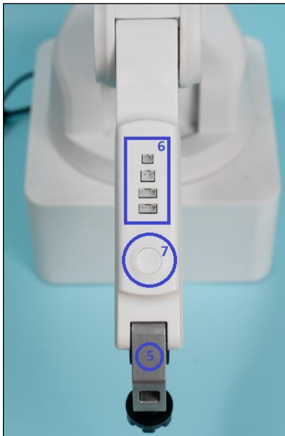
Рисунок 9 – Стрела манипулятора (вид сверху), где: 6 – панель разъемов для подключения сменных модулей; 7 – кнопка FreeDrive
