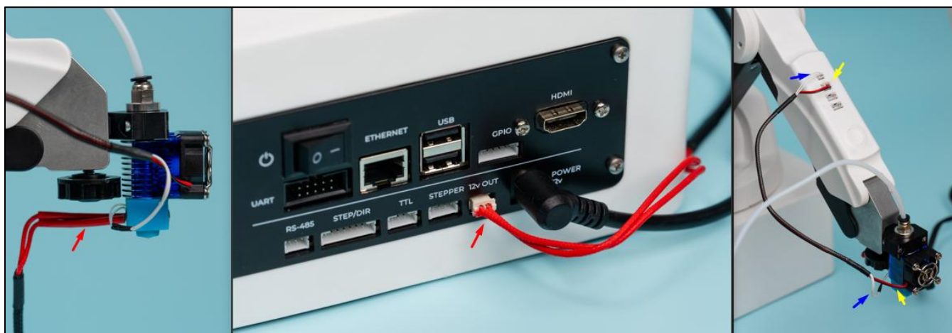
Рисунок 24 – Подключение провода датчика температуры и вентилятора
