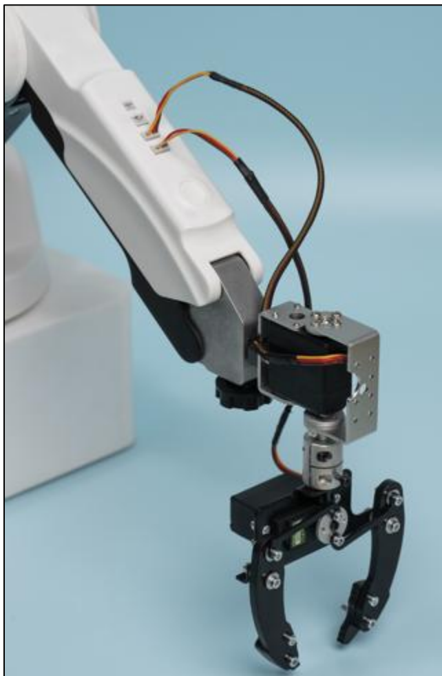
Рисунок 20 – Подключение проводов механического захвата
