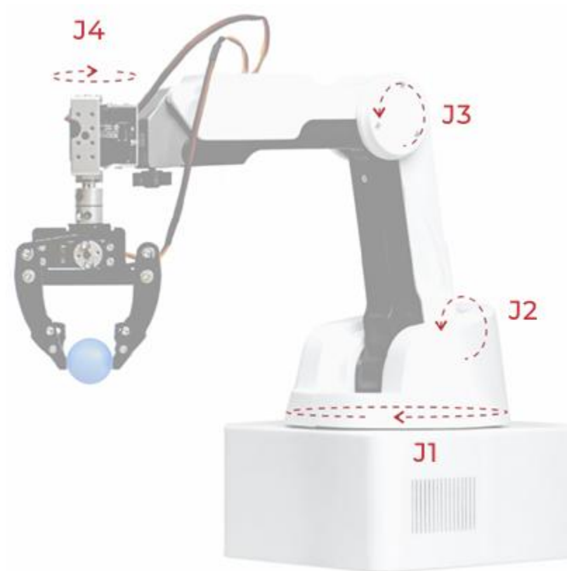
Рисунок 8 – Движение плеча и стрелы манипулятора
