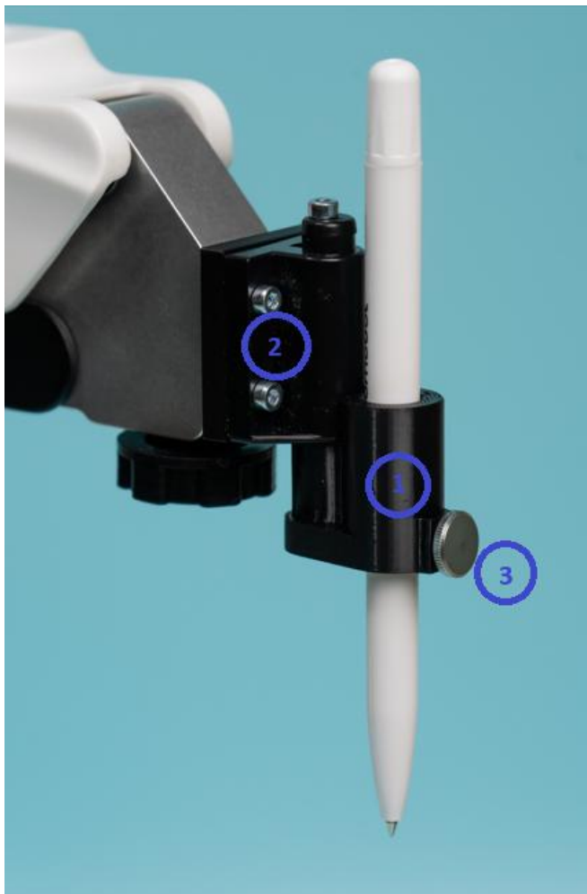
Рисунок 20 – Модуль захвата пишущего инструмента, где: 1 – захват пишущего инструмента; 2 – держатель захвата; 3 – винт
