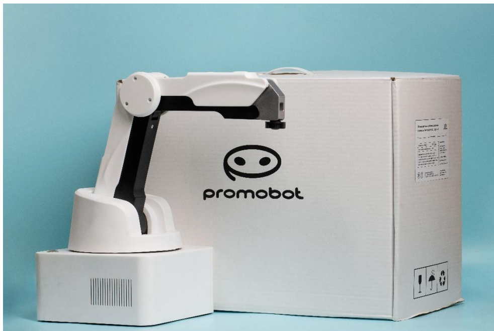
Рисунок 2 – Настольный 4-х осевой манипулятор
