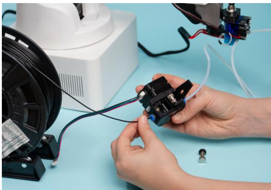
Рисунок 25 – Заправка пластиковой нити в экструдер
