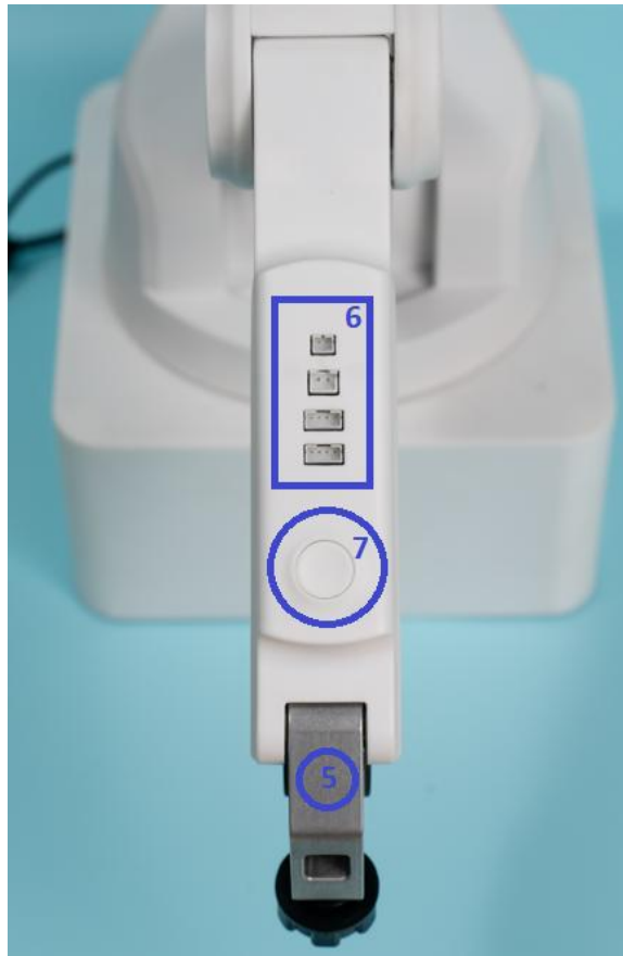
Рисунок 9 – Стрела манипулятора (вид сверху), где: 6 – панель разъемов для подключения сменных модулей; 7 – кнопка FreeDrive
