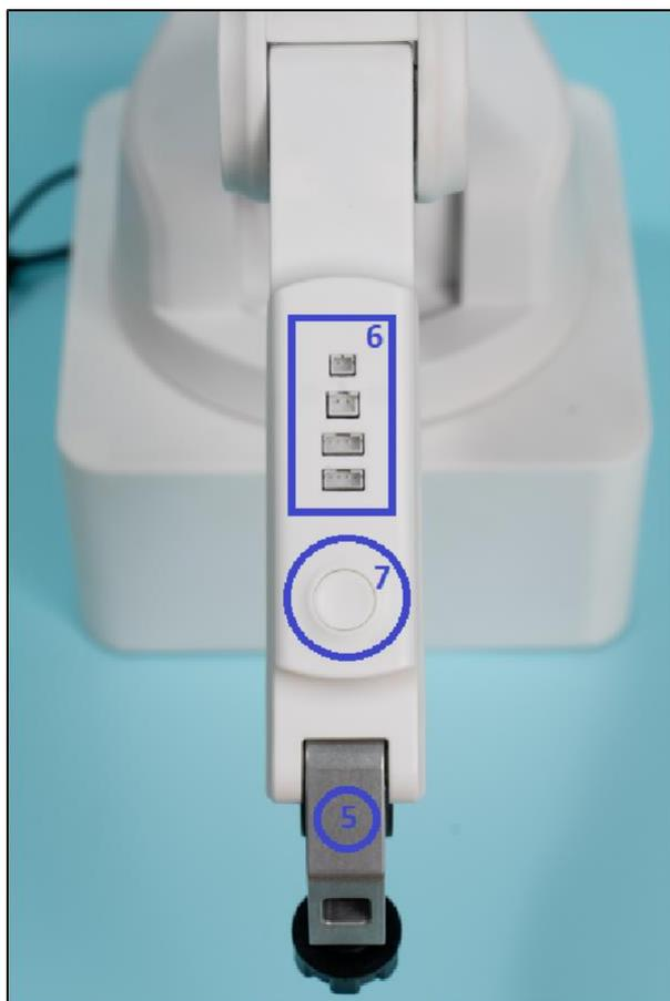
Рисунок 8 – Стрела манипулятора (вид сверху), где: 6 – панель разъемов для подключения сменных модулей; 7 – кнопка FreeDrive
