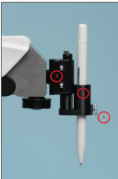
Рисунок 17 – Модуль захвата пишущих инструментов, где: 1 – захвата пишущих инструментов; 2 – держатель захвата; 3 – винт
