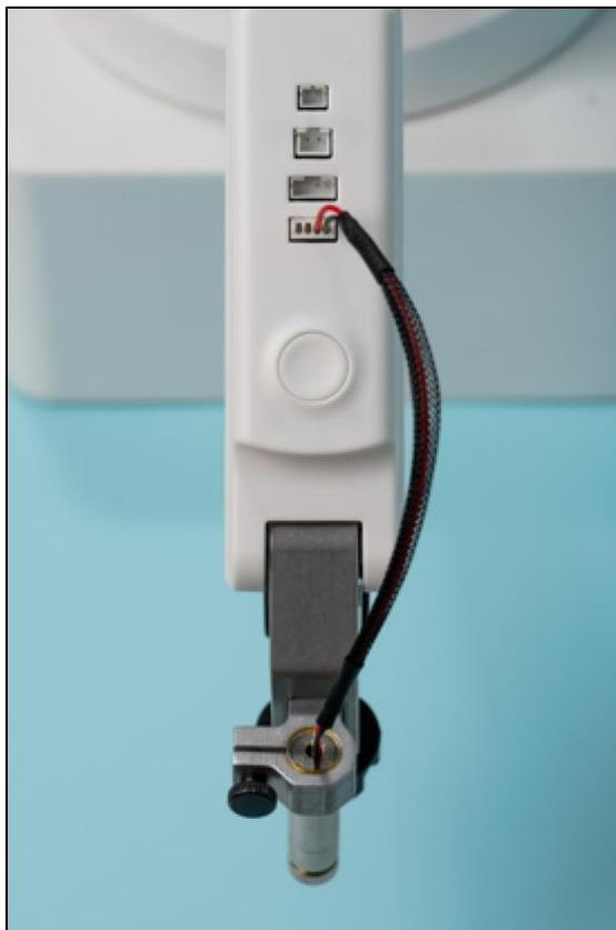
Рисунок 26 – Подключение проводов лазерной головки
