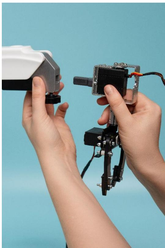
Рисунок 12 – Установка поворотного модуля инструмента
