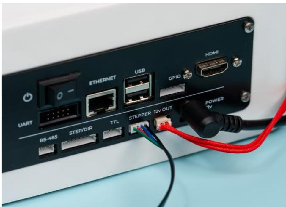
Рисунок 23 – Подключение проводов экструдера
