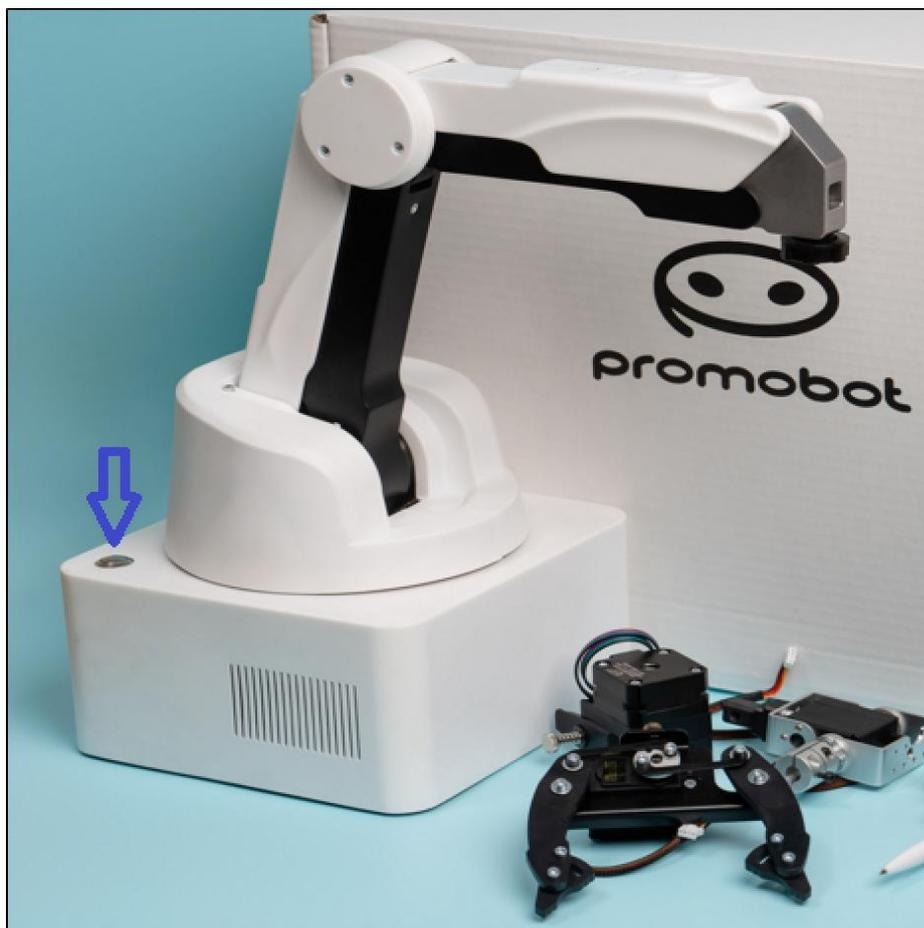
Рисунок 5 – Кнопка включения/выключения манипулятора
