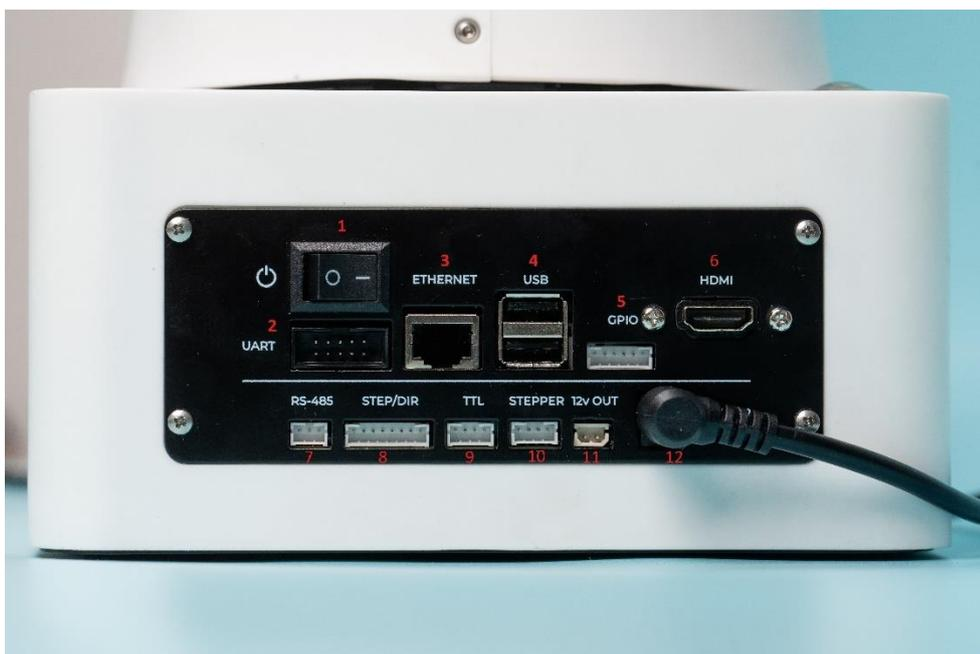
Рисунок 3 – Панель разъемов для подключения внешних устройств
