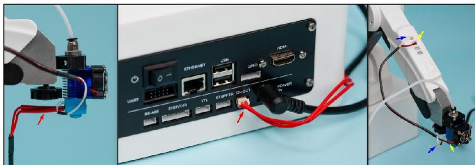
Рисунок 20 – Подключение провода датчика температуры и вентилятора
