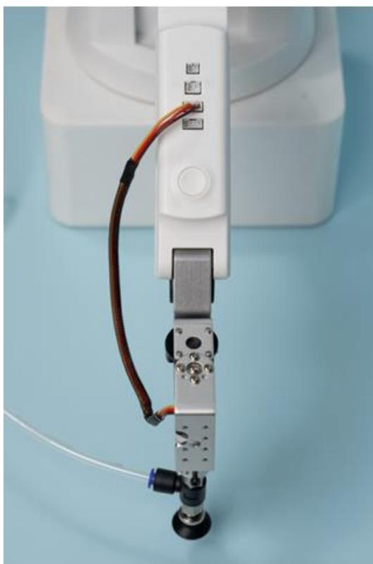
Рисунок 13 – Подключение проводов поворотного модуля
