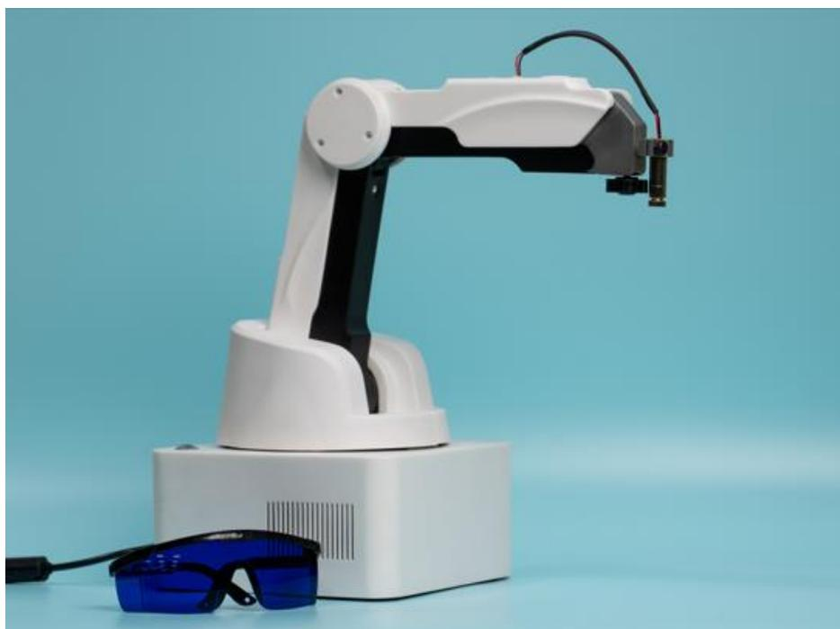
Рисунок 25 – Модуль лазерной гравировки
