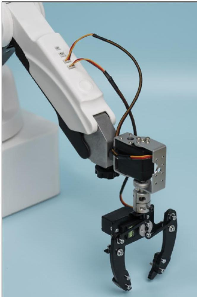
Рисунок 16 – Подключение проводов механического захвата
