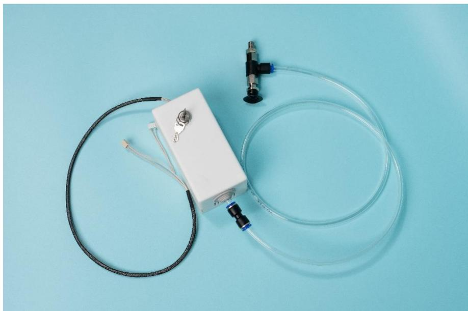
Рисунок 10 – Внешний блок коммутации инструмента
