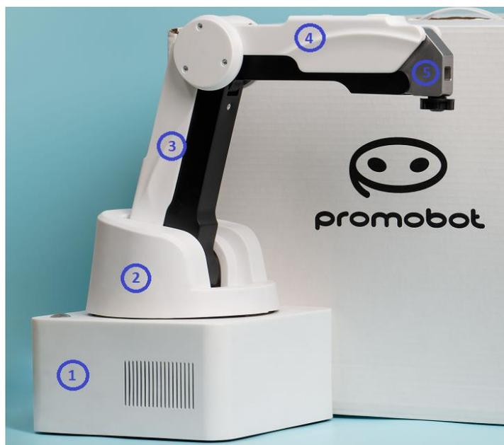
Рисунок 6 – Манипулятор, где: 1 – башня; 2 – плечо; 3 – стрела; 4 – блок инструмента
