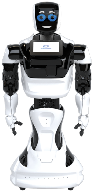
Рисунок 2.6. Руки-манипуляторы в нулевой позиции
