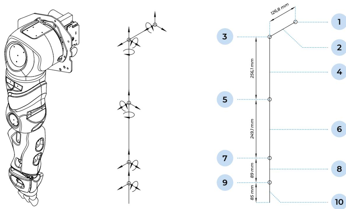
Рисунок 2. Кинематическая схема Rooky
