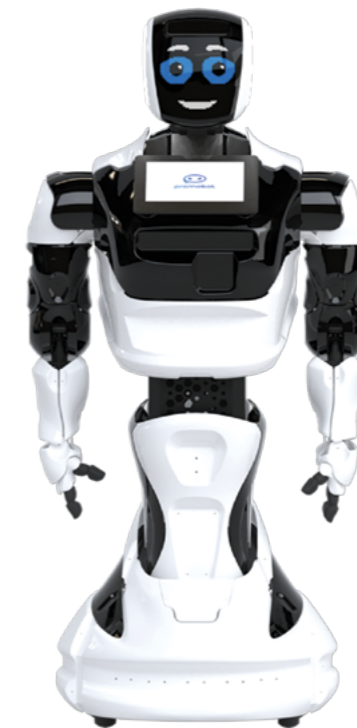
Рисунок 2.6. Руки-манипуляторы в нулевой позиции
