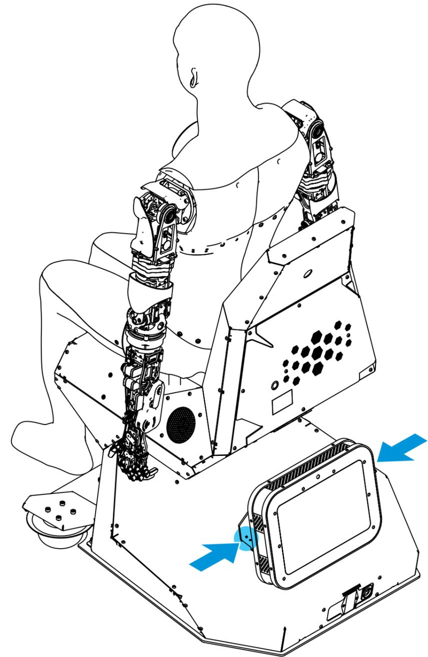
\* зафиксировать штатное крепление дисплея винтами на платформе
